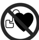
**Не встановлюйте вимірювальний прилад поблизу кардіостимулаторів.** Магніт створює поле, яке може негативно впливати на функціональну здатність кардіостимулатора.
