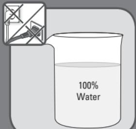
مخزن آب را تا حداقل حد آن با 100% آب لوله‌کشی پر کنید و این عملیات را دوباره تکرار کنید تا زمانی که مخزن آب کاملاً خالی شود و بعد دستگاه را تمیز کنید.
