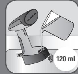
**DA** Vandbeholderen må højst fyldes med 120 ml ubehandlet vand fra hanen (2 bæger af 60 ml) (se afsnittet »Brug følgende slags vand»).
