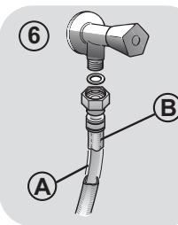
● **АКВАПРОТЕКТ** («Система захисту від протікання») – ВОДОНАЛИВНИЙ ШЛАНГ З ДОДАТКОВИМ ЗАХИСТОМ (Рис.6): Якщо вода протече з головного внутрішнього шлангу «A», то вона потрапить до прозорої захисної зовнішньої оболонки «B», що дозволить закінчити цикл прання. Після завершення циклу прання зверніться до Центру з Обслуговування Клієнтів, щоб замінити водоналивний шланг.
