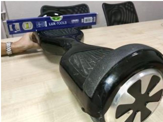
Nachdem Sie sich vergewissert haben, dass beide Räder korrekt waagerecht ausgerichtet sind, drücken Sie ca. 5 Sekunden lang auf die POWER-Taste, bis die blauen Lichter anfangen, zu pulsieren.
