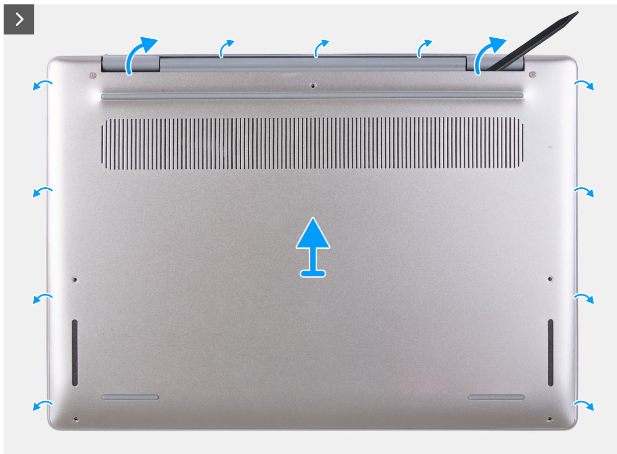
Rysunek 16. Wymontowywanie pokrywy dolnej
