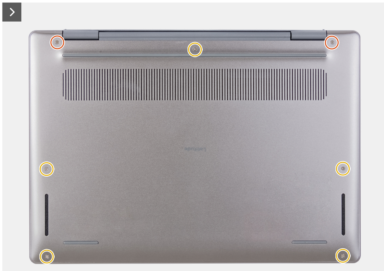
Rysunek 15. Wymontowywanie pokrywy dolnej
