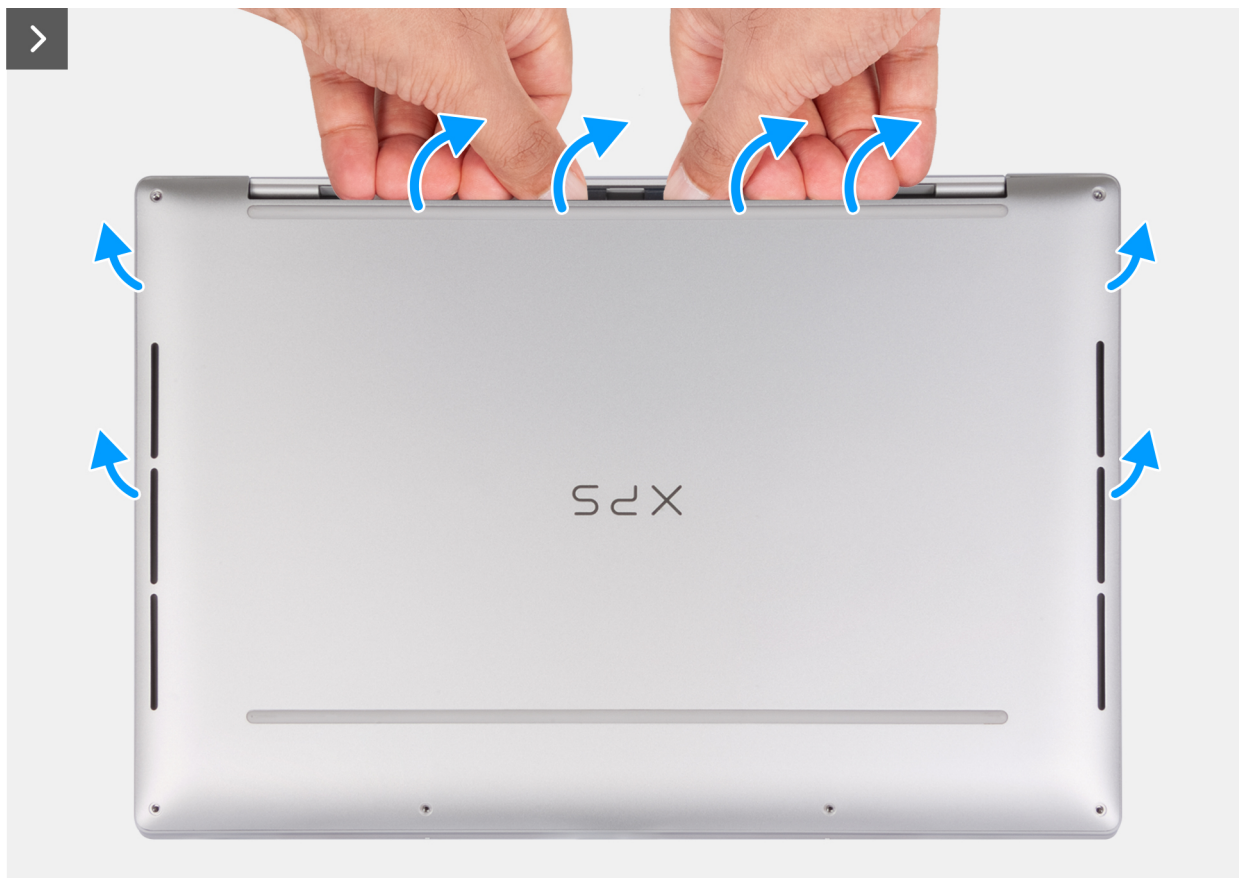
Rysunek 11. Wymontowywanie pokrywy dolnej
