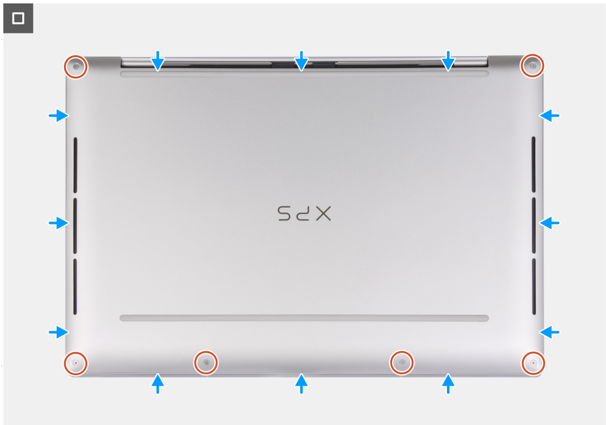
Rysunek 16. Instalowanie pokrywy dolnej
