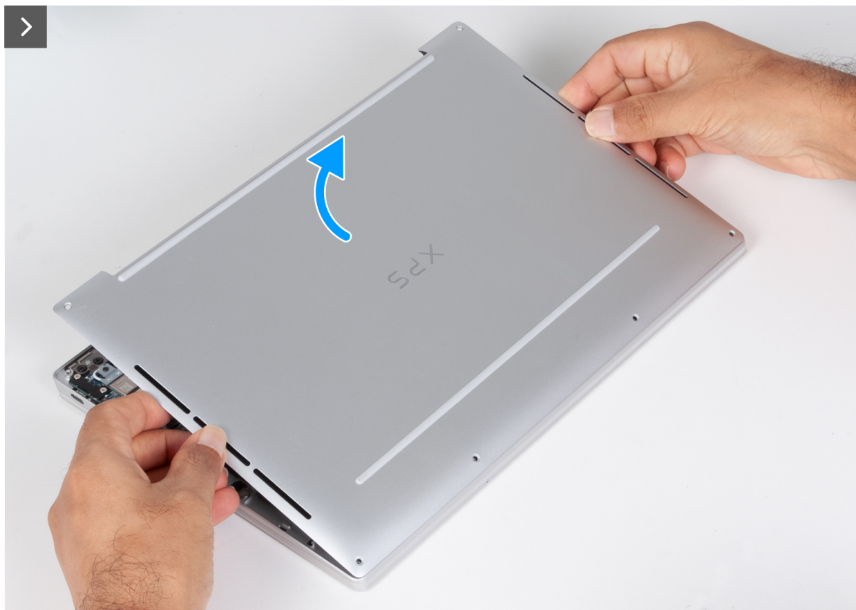
Rysunek 12. Wymontowywanie pokrywy dolnej
