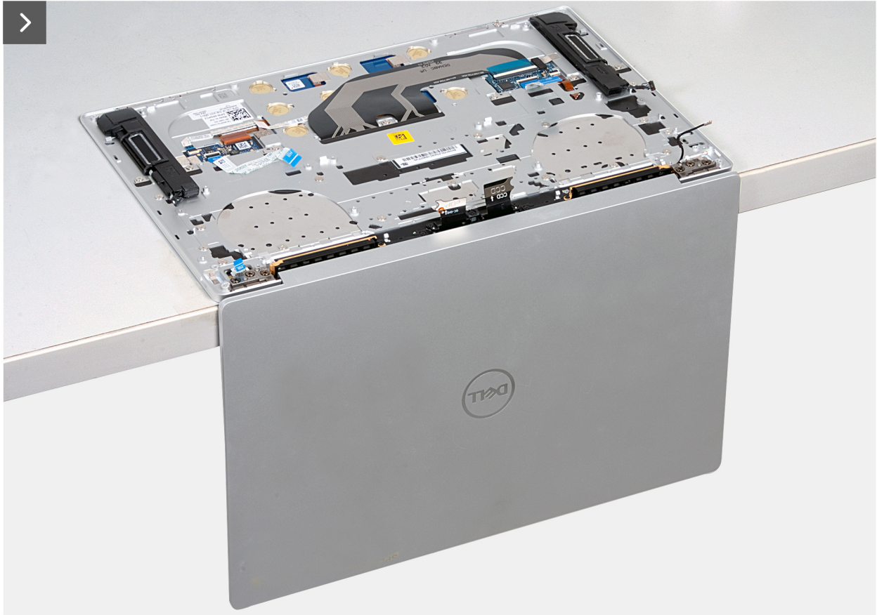
Rysunek 55. Wymontowywanie klawiatury
