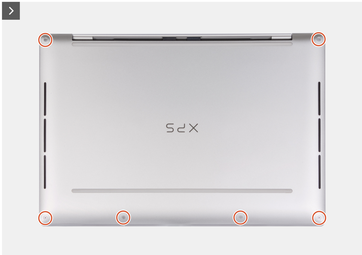
Rysunek 10. Wymontowywanie pokrywy dolnej
