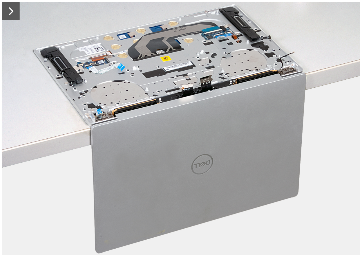
Rysunek 59. Instalowanie klawiatury
