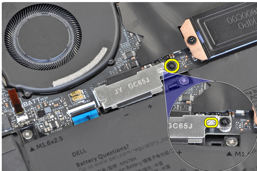
Rysunek 25. Klamra złącza baterii
