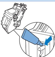
Aby zapewnić optymalne działanie urządzenia, smaruj jednostkę zaparzającą po zaparzeniu 500 filiżanek kawy lub co trzy miesiące. Zadzwoń pod numer Centrum Obsługi Klienta firmy Philips Saeco, aby kupić smar.
