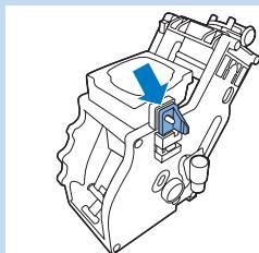
*Uwaga: Zaczep blokujący znajduje się z tyłu jednostki zaparzającej (bok bez słowa „push”) na górze poziomej krawędzi.*
