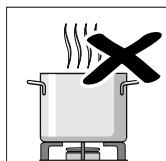
Așezați recipientele pe grătare, niciodată direct pe arzător.
