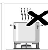
Umieszczać naczynie na palniku w położeniu dokładnie centrycznym. W przeciwnym razie może się ono wywrócić.
