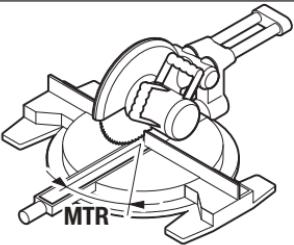
Одново притиснете го копчето **7**. На екранот се појавуваат „**MTR**“ и пресметаниот хоризонтален агол на закосување за пилата за отсекување и сечење под агол.
