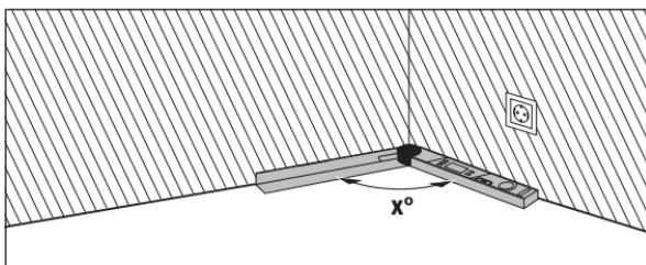
Mají-li být obrobky vsazeny do rohu (např. pro podlahové lišty), pak změřte úhel rohu **x°** přiložením sklopného ramene a ramene základny. Pro zadání úhly (např. rámy obrazů) rozevřete sklopné rameno a rameno základny napotík, až se na displeji zobrazí požadovaný úhel.
