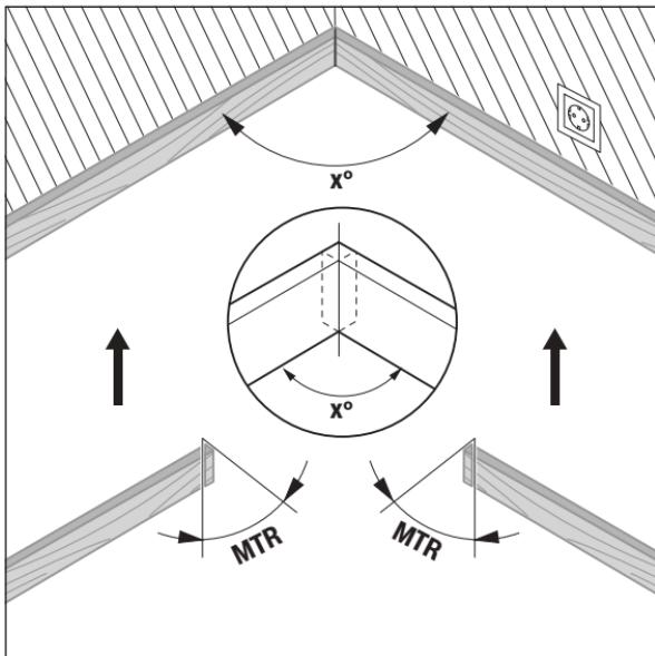
Se calculează unghiul de înclinare în plan orizontal „**MTR**“ („Miter Angle“: unghi de înclinare în plan orizontal), în care se vor tăia cele două piese de lucru. La aceste tăieri oblice pârza de ferăstrău este perpendiculară pe piesa de lucru (unghiul de înclinare în plan vertical este de  $0^\circ$ ).
