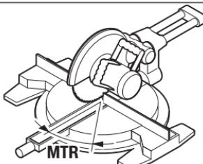
Нажмите на кнопку «**MTR**» **8**. До тех пор, пока Вы нажимаете на кнопку «**MTR**» **8**, будет отображаться рассчитанный горизонтальный угол скоса «**MTR**», который нужно настроить на торцовочно-усорезной пиле. Одновременно на дисплее загорается индикатор «**MTR**».
