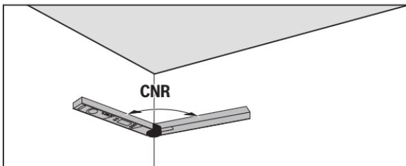
Sklopivi i osnovni krak za merenje ugla čoška položite ravno na zid ili podesite poznati ugao čoška na mernom alatu.
