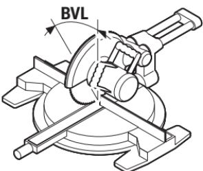
Натиснете отново бутона **7**. На дисплея се появяват символът „**BVL**“ и изчисленияят ъгъл на скосяване във вертикална равнина за циркулярната машина.
