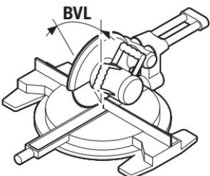
Dar kartą paspauskite mygtuką **7**. Ekrane parodomasis „**BVL**“ ir apskaičiuotas įstrižo pjūvio vertikalioje plokštumoje kampas skersavimo ir suleidimo pjūklui.
