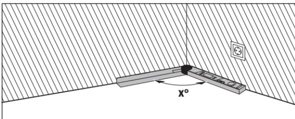
Ha a munkadarabokat egy sarokba kell beilleszteni (például padlólélékhez), akkor a kihajtható és az alapszár felhelyezésével mérje meg a  $x^\circ$  sarokszöget. Egy adott szögértékhöz (például képkeret) nyissa szét annyira a kihajtható és az alapszárat, hogy a kívánt szögérték kerüljön kijelzésre.
