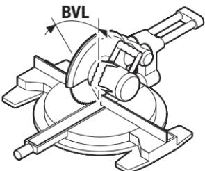
Apăsați din nou tasta **7**. Pe display apar „**BVL**“ și unghiul de înclinare în plan vertical calculat pentru ferăstrăul circular stătiorar.
