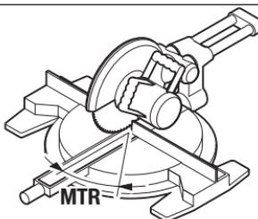
Притиснете го копчето „MTR“ 8. Сè додека го држите притиснатото копчето „MTR“ 8, ќе се прикажува пресметаниот хоризонтален агол на закосување „MTR“, кој мора да се постави на пилата за отсекување и сечење под агол. Истовремено светнува индикаторот „MTR“ на екранот.
