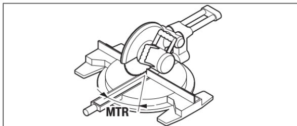
Apăsați tasta „**MTR**“ **8**. Atât timp cât veți ține apăsată tasta „**MTR**“ **8**, va fi afișat unghiul calculat de înclinare în plan orizontal „**MTR**“, care trebuie reglat la ferăstrăul circular staționar. Concomitent, pe display luminează indicatorul „**MTR**“.
