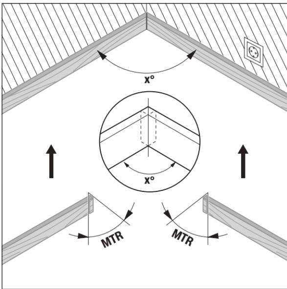
Изчислява се ъгълът на скосяване в хоризонтална равнина „MTR“ („Miter Angle“: ъгъл на скосяване в хоризонтална равнина), под който трябва да бъдат отрязани двета детайла. При отрязването циркулярен диск е перпендикулярен на детайла (ъгълът на скосяване във вертикална равнина е  $0^\circ$ ).
