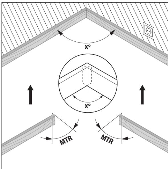
Екі дайындағы қысқаратын “**MTR**” (“Miter Angle”: горизонталды қисаю бұрышты) горизонталды қисаю бұрышы есептеледі. Ара полотносы осы қисаю бұрыштарда дайындаға көлденен тұрады (вертикалды қисаю бұрышы  $0^\circ$ ).
