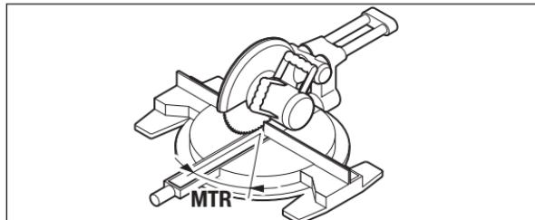
Знову натисніть кнопку **7**. На дисплей виїсвічується «**MTR**» і вираховане значення горизонтального кута розпилювання для торцювально-вусорізної пилки.
