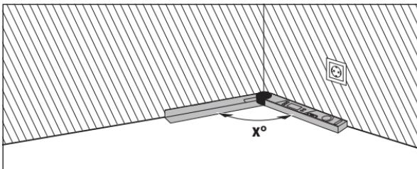
Ako se izraci trebaju pripasati u ugлу (npr. za podne letvice), u tom slučaju izmjerite kut u ugлу **x°** polaganjem preklopnog i osnovnog kraka. Za pret- hodno zadani kut (npr. okvir za sliku) otvorite preklopni i osnovni krak toli- ko dok se na displeju ne pokaže traženi kut.
