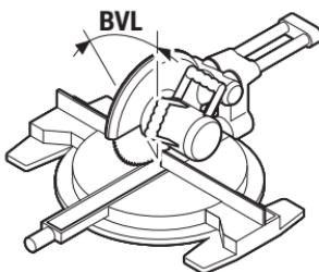
Nyomja meg ismét a **7** gombot. A kijelzőn megjelenik a „**BVL**” és a számított függőleges sarkalószög a rövidítő és sarkaló fűrész számára.
