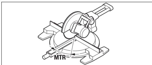
Stiskněte znova tlačítko 7. Na displeji se objeví „**MTR**“ a vypočítaný horizontální úhel pokosu pro kapovací a pokosovou pilu.
