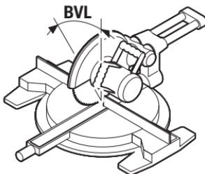
Stlačte znova tlačidlo **7**. Na displeji sa zobrazí „**BVL**“ a vypočítaný vertikálny uhol zošikmenia pre kapovaciú a pokosovú pílu.
