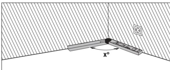
Če želite obdelovance prilagoditi v kot (npr. talne letvice), potem izmerite vogalne kote **x°** s prileganjem zložljivega in osnovnega traka. Za vnaprej podane kote (npr. okvir) odprite zložljiv v osnovni krak tako daleč, da se željen kot prikaže na displeju.
