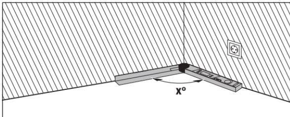
Ak majú byť dva obrobky zapasované do kúta (napríklad podlahové lišty), potom odmerajte rohový uhol **x°** priložením sklopacieho a základného ramena. Pre vopred stanovené uhly (napríklad rámy obrazov) otvorte sklopacie a základné rameno natol'ko, aby sa na displeji zobrazil požadovaný uhol.
