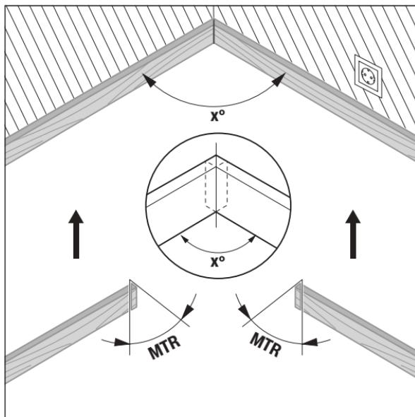
Välja arvutatakse horisontaalne kaldenurk „MTR“ („Miter Angle“: horisontaalne kaldenurk), mille võrra tuleb kahte toorikut lühendada. Saeketas on nende kallilöigete puhul tooriku suhtes vertikaalselt (vertikaalne kaldenurk on  $0^\circ$ ).
