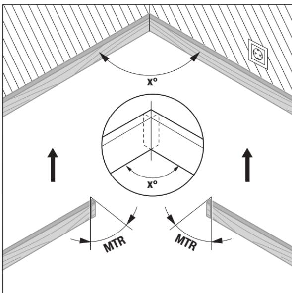
Vypočítán bude horizontální úhel pokusu „MTR“ („Miter Angle“: horizontální úhel pokusu), o který musejí být zkráceny oba obrobky. Pilový kotouč stojí u téchto pokosových řezů kolmo vůči obrobku (vertikální úhel sklonu činí  $0^\circ$ ).
