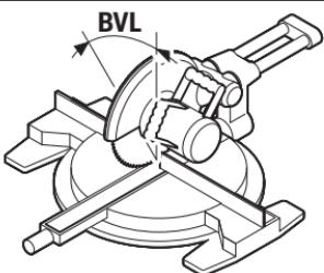
Вновь нажмите кнопку **7**. На дисплее отображается «**BVL**» и рассчитанный вертикальный угол распила для торцовочно-усорезной пилы.
