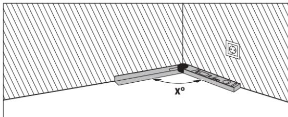
Ako radni komadi treba da se stave napasuju u ugao (na primer za letve za podove), onda izmerite ugao čoška **x°** naleganjem prekopljenog i baznog kraka. Za zadate uglove (na primer okvire za slike) otvorite prekopljene i bazne krakove toliko, sve dok se ne prikaže na displeju željeni ugao.
