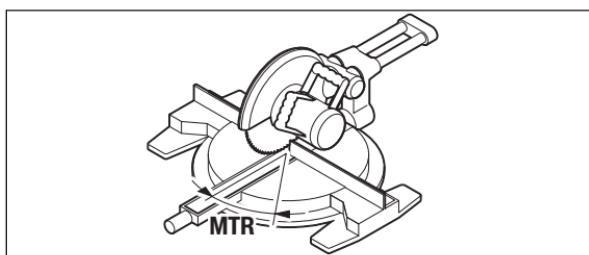
Натиснете отново бутона **7**. На дисплея се появяват символът „**MTR**“ и изчисленияния ъгъл на скосяване в хоризонтална равнина за циркулярната машина.
