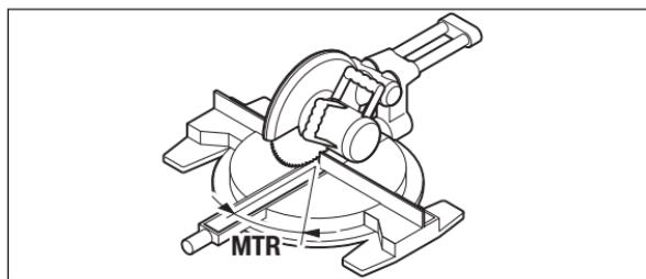
Вновь нажмите кнопку **7**. На дисплее отображается «**MTR**» и рассчитанный горизонтальный угол распила для торцовочно-усоренной пилы. По горизонтальному углу скоса задается поворот стола (**MTR**).
