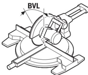
Stiskněte znova tlačítko **7**. Na displeji se objeví „**BVL**“ a vypočítaný vertikální úhel sklonu pro kapovací a pokosovou pilu.
