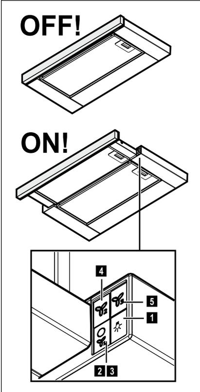
1. Вклучување/Исклучување на светлото
