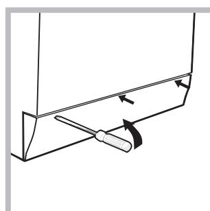
1. αφαιρέστε το ταμπλό κάλυψης στο πρόσθιο πλευρό του πλυντηρίου με τη βοήθεια ενός κατασβιδιού (βλέπε *εικόνα*).
